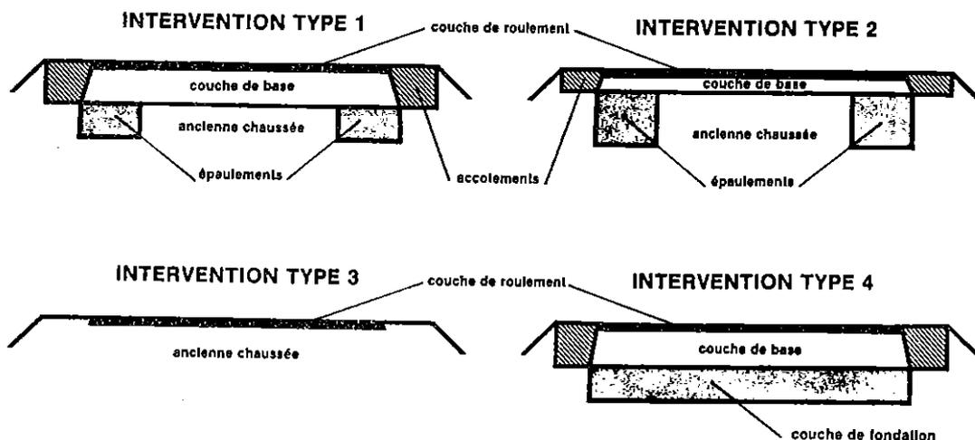
**Economie d'énergie !** Le projet initial de renforcements coordonnés de la RN 85 préconisait de la grave bitume (gravillons + dérivés du pétrole) pour la couche de base. Dans le souci d'économiser l'énergie, cette grave bitume est remplacée dans le projet définitif par de la grave hydraulique (Remplacement du liant « bitume » par un liant « blanc » non dérivé du pétrole : ciment, chaux, cendre, laitier,...).
